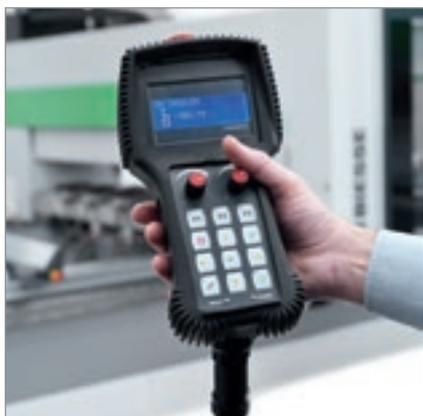
**Console à distance** pour un contrôle direct et immédiat par l'opérateur.
